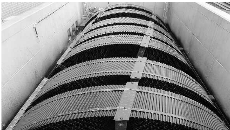
Figure 20 : disque biologique rotatif
