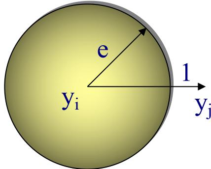
Une erreur de poids  $\leq e$  sur  $y_i$  est détectable s'il n'existe **aucun mot** du code  $y_j$  situé à **l'intérieur** de l'hypersphère de rayon  $e$  et de centre  $y_i$
