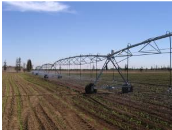
Figure III-9 : Pivots, rampes frontales.
